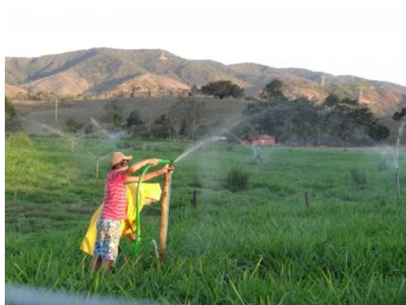
Coleta de água do aspersor para caracterização do sistema de irrigação da propriedade do participante José Carlos Lopes, do município de Mutum-MG.
