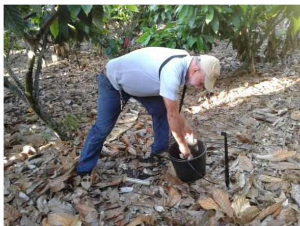
Coleta de água do microaspersor para caracterização do sistema de irrigação da propriedade do participante José Vilson Margotto, do município de Colatina-ES.
