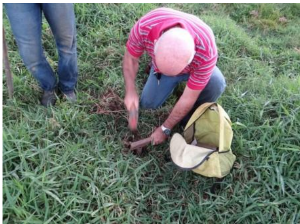
Amostragem para caracterização físico-hídrica do solo da propriedade do participante José Carlos Lopes, do município de Mutum-MG.
