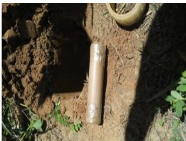
Amostragem para caracterização físico-hídrica do solo da propriedade do participante Romildo Teodoro Rodrigues do município de Ipanema-MG.
