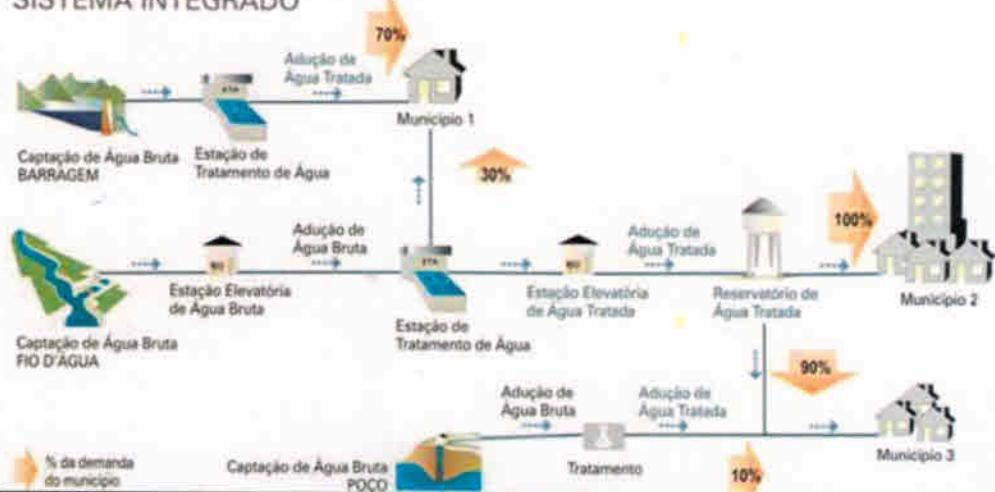
Figura 1 – Esquema de sistema integrado de produção de água
