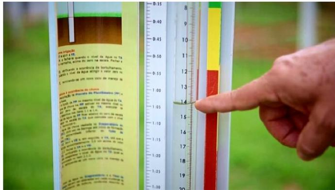
FIGURA 32. Nível da água posicionada na direção da faixa vermelha da régua de manejo do Irrigâmetro.
