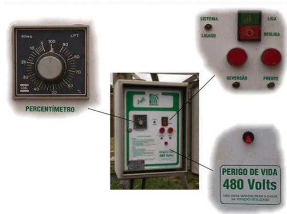
FIGURA 13. Detalhe do painel de controle do pivô central.
