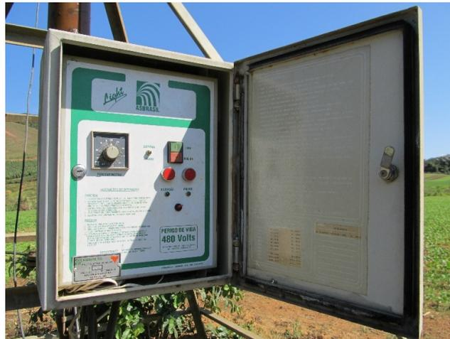
FIGURA 12. Painel de controle analógico de um pivô central.
