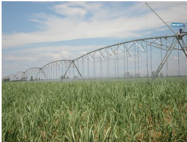
FIGURA 9. Pivô central irrigando cana-de-açúcar.
