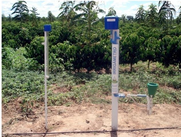
FIGURA 27. Irrigâmetro usado no manejo da irrigação do cafeeiro.
