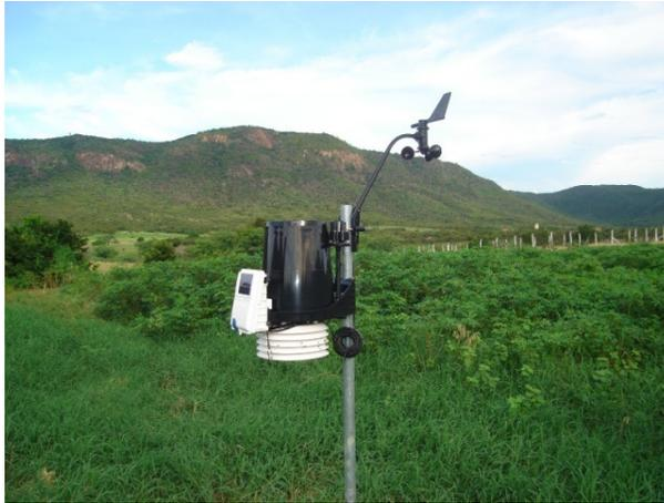
FIGURA 26. Estação meteorológica automática.
