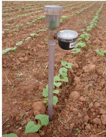
FIGURA 23. Tensiômetro sendo usado no manejo da irrigação do feijoeiro.
