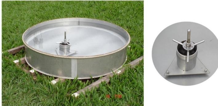
FIGURA 25. Tanque Classe A com detalhe do micrômetro de gancho.
