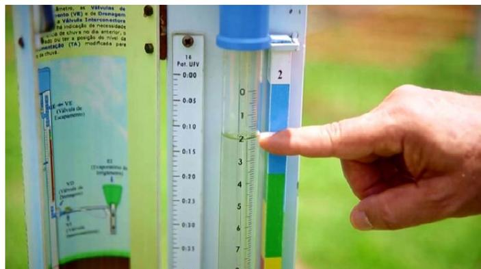
FIGURA 29. Nível da água posicionada na direção da faixa azul da régua de manejo do Irrigômetro.
