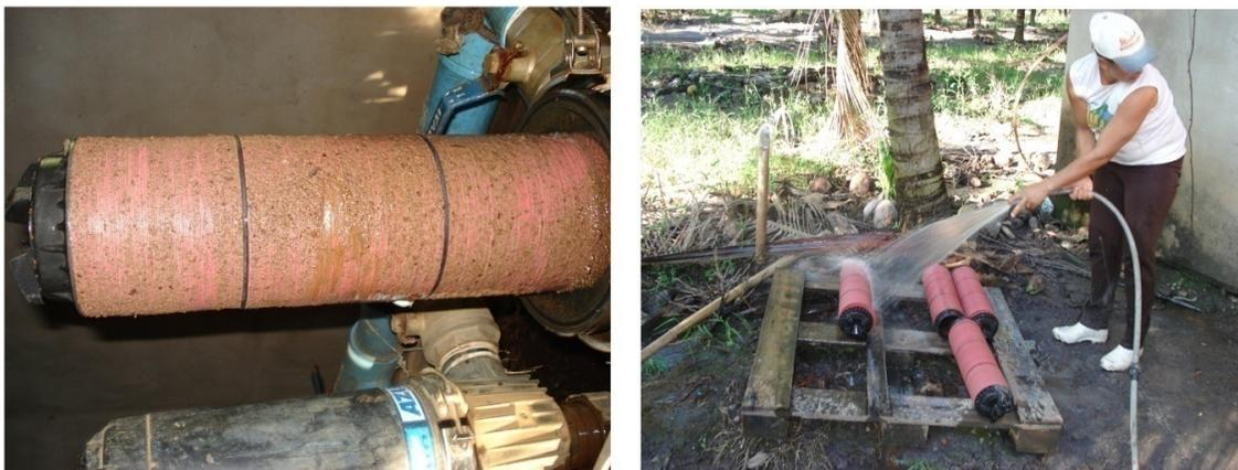
FIGURA 1. Deposição de ferro no cartucho do filtro de discos e limpeza com uso de jato de água.
