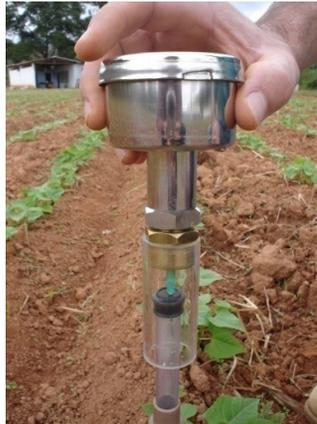
FIGURA 24. Uso de tensímetro digital e tubo tensiométrico no manejo da irrigação do feijoeiro.
