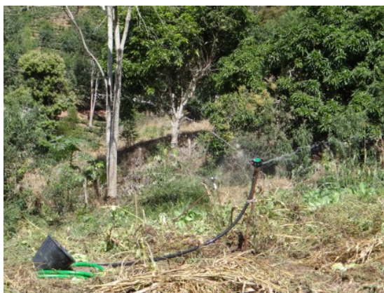
Coleta de água do aspersor para caracterização do sistema de irrigação em olerícolas na propriedade da participante Júlio César Sathler do município de Manhumirim-MG
