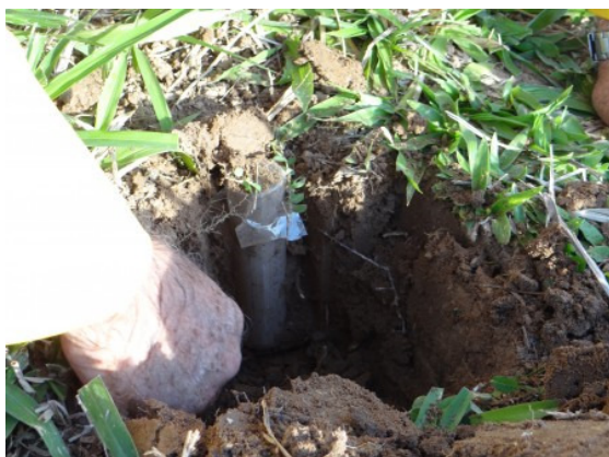
Amostragem para caracterização físico-hídrica do solo da propriedade do participante Cários Iran Cardoso do município de Mutum-MG
