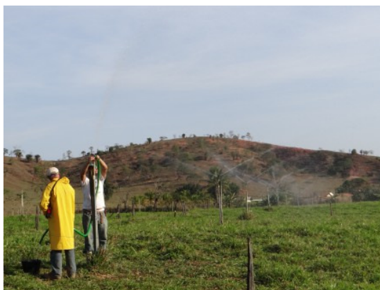
Coleta de água do aspersor para caracterização do sistema de irrigação da propriedade do participante Cários Iran Cardoso do município de Mutum-MG
