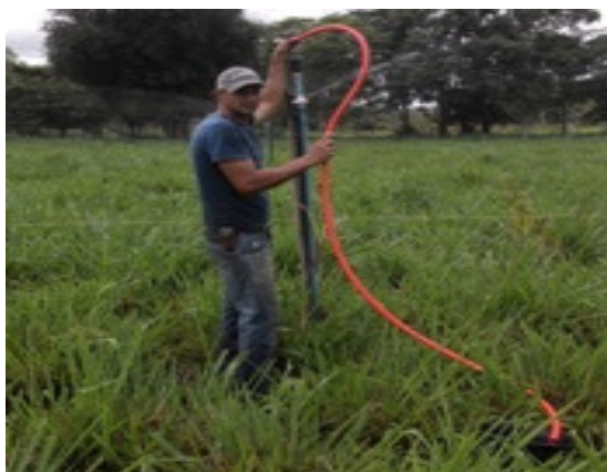
Coleta de água do aspersor para caracterização do sistema de irrigação de capim em piquetes da propriedade do participante Edmundo Kuhlmann Neto do município de Ipanema-MG.
