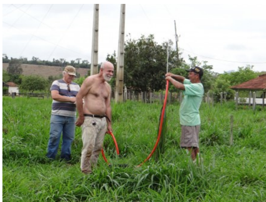
Coleta de água do aspersor para caracterização do sistema de irrigação da propriedade do participante Luiz Henrique Siqueira do município de Mutum-MG
