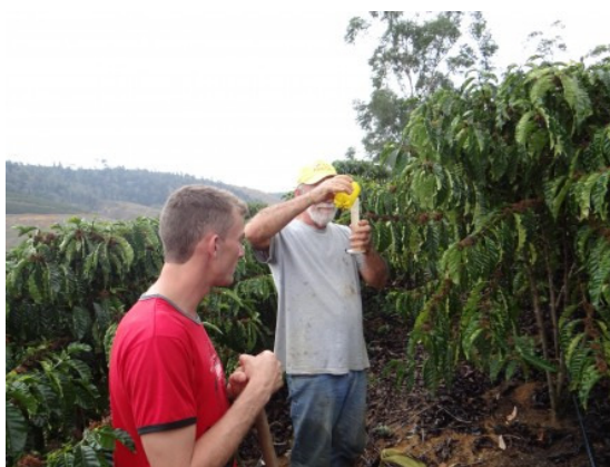
Medição do volume de água do microspray para caracterização do sistema de irrigação da propriedade do participante José Gon do município de Colatina-ES
