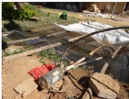
Captação de água para atender o sistema de irrigação por aspersão da propriedade do participante Milton Rodrigues Bento do município de Simonésia-MG
