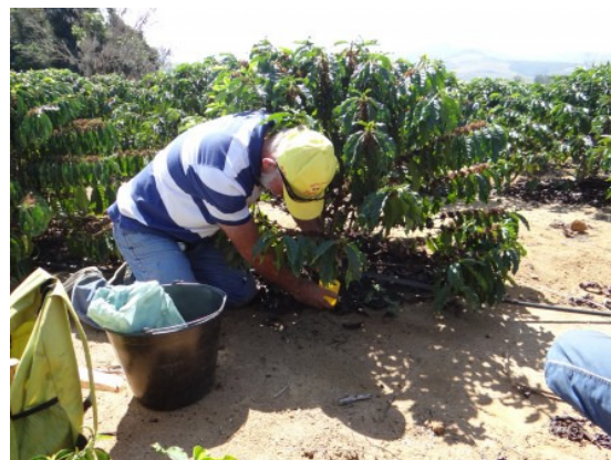
Coleta de água do microspray para caracterização do sistema de irrigação da propriedade do participante Nilson Zupele do município de Colatina-ES.
