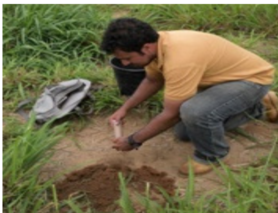
Amostragem para caracterização físico-hídrica do solo da propriedade do participante Edmundo Kuhlmann Neto do município de Ipanema-MG.
