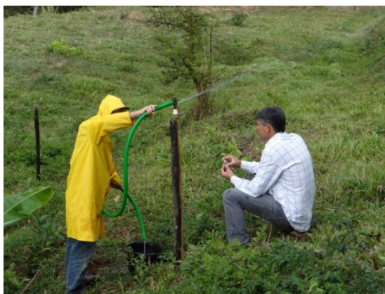
Coleta de água do aspersor para caracterização do sistema de irrigação da propriedade do participante João Batista da Silva do município de Mutum-MG
