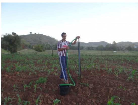
Coleta de água do aspersor para caracterização do sistema de irrigação da propriedade do participante José Vinício de Souza do município de Mutum-MG
