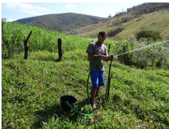
Coleta de água do aspersor para caracterização do sistema de irrigação da propriedade do participante Nério Justino da Silva do município de Mutum-MG
