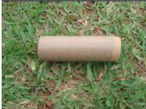
Figura 6. Segmento de tubo de PVC com uma extremidade biselada.
