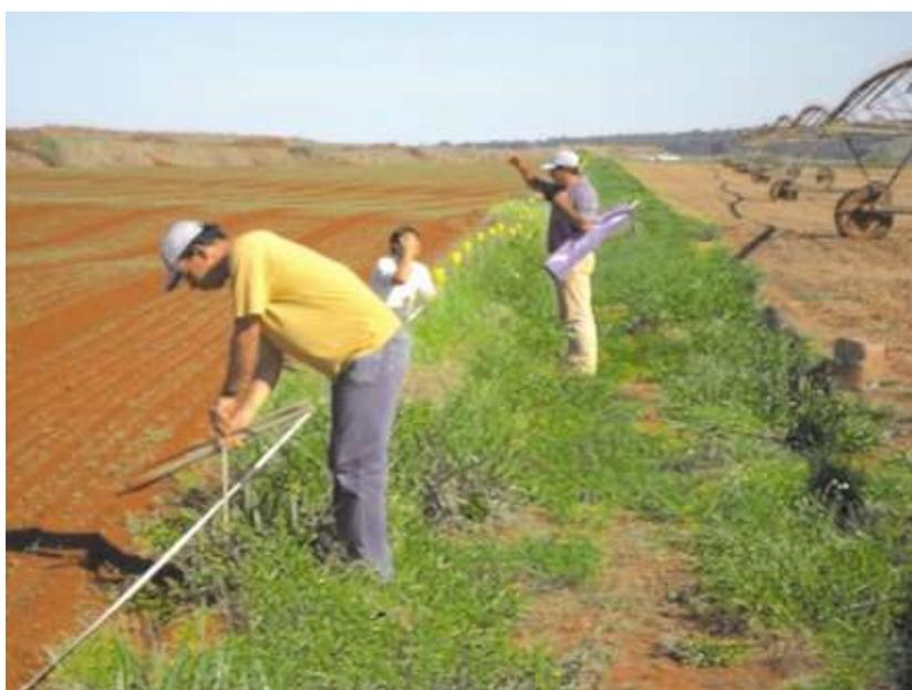
Figura 21. Marcação da posição e colocação dos coletores ao longo de um raio do círculo de molhamento de um pivô central.
