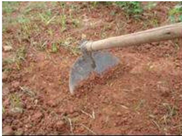
Figura 7. Limpeza e nivelamento do local de amostragem.
