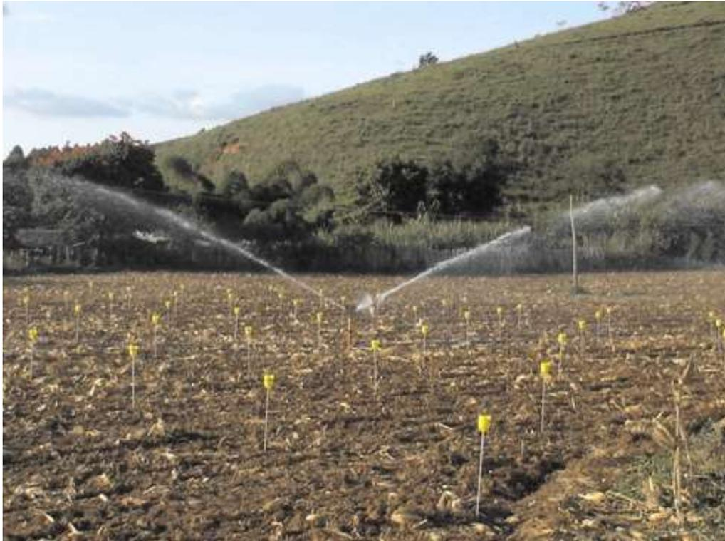
Figura 18. Teste de uniformidade de aplicação de água de um sistema de aspersão convencional, mostrando a distribuição dos coletores na área irrigada.
