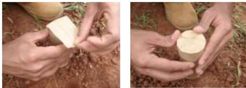
Figura 15. Vedação das extremidades do tubo de PVC com fita adesiva.
