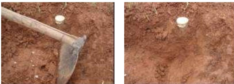
Figura 12. Escavação lateral ao tubo de PVC.
