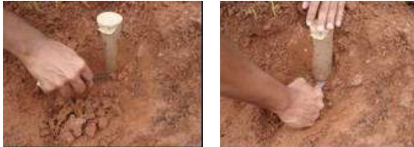
Figura 13. Limpeza do tubo de PVC e corte do solo na sua base, para retirada da amostra.
