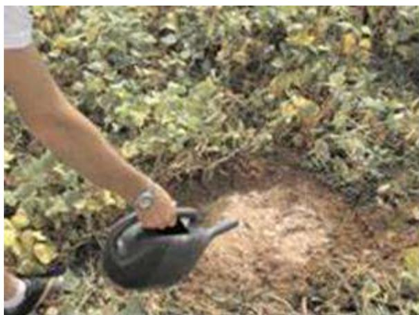
Figura 8. Umedecimento do solo para retirada de amostra pelo Método do Tubo de PVC.
