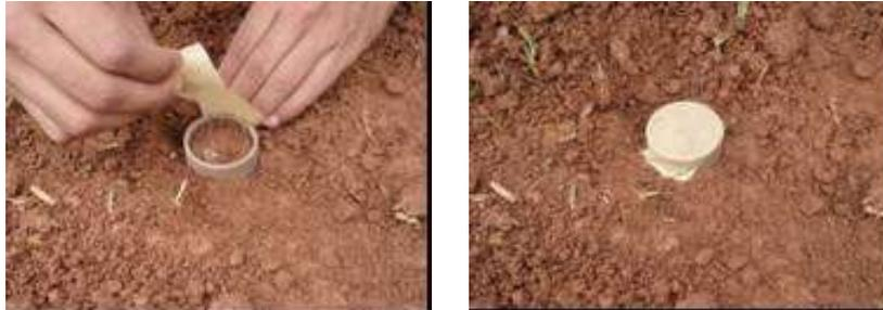
Figura 11. Vedação da borda superior do segmento de tubo de PVC.
