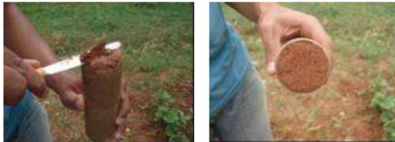
Figura 14. Retirada do excesso de solo e nivelamento da parte de baixo da amostra.
