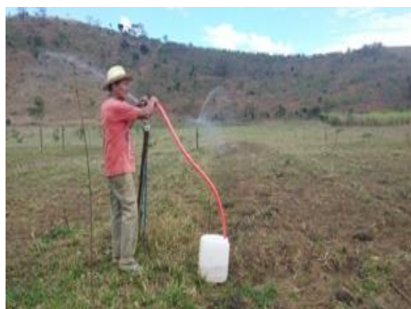
Coleta de água do microaspersor para caracterização do sistema de irrigação da propriedade do participante José Geraldo Pereira, do município de Malacacheta-MG
