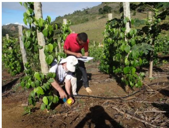
Coleta de água do microspray para caracterização do sistema de irrigação da propriedade do participante Paulo Lorencini do município de Vila Valério - ES.
