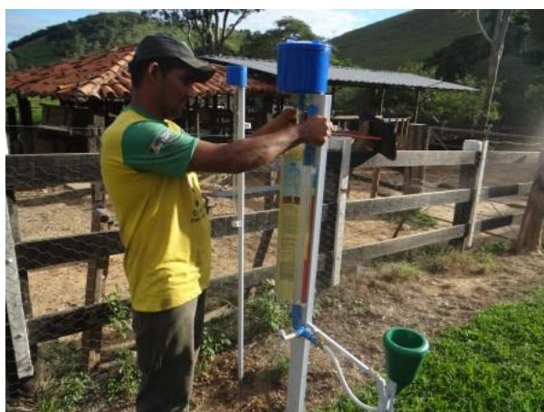
FIGURA 119. Instalação do Irrigâmetro na propriedade e treinamento do produtor José Antônio Rodrigues, do município de Tarumirim - MG.
