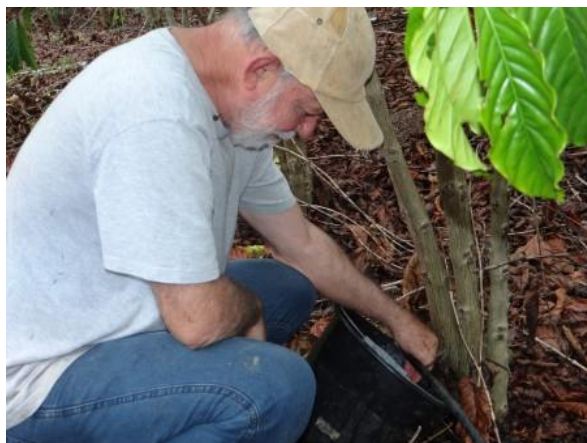
Coleta de água do emissor para caracterização do sistema de irrigação por gotejamento em café, na propriedade de Waldemar Alves Pereira
