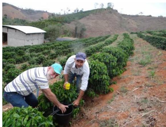
Coleta de água do emissor para caracterização do sistema de irrigação por microaspersão em café, na propriedade de Adelson Rossmann.
