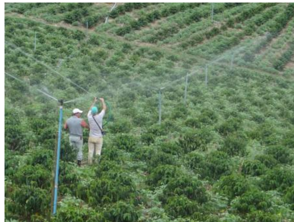
Coleta de água do aspersor para caracterização do sistema de irrigação por aspersão em café, na propriedade de José Alaor Bissoli
