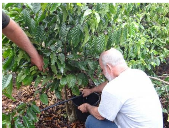
Coleta de água do emissor para caracterização do sistema de irrigação por gotejamento em café, na propriedade de João Luís da Silva.
