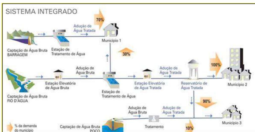
Figura 144 - Esquema de sistema integrado de produção de água
