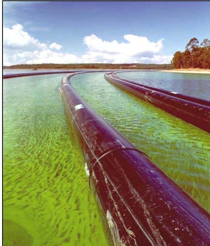
Figura 4.11 Represas Billings, Taquacetuba e Guarapiranga em São Paulo – Floração de Cianobactérias, Captação flutuante para reduzir a captação de algas na água a ser tratada.
