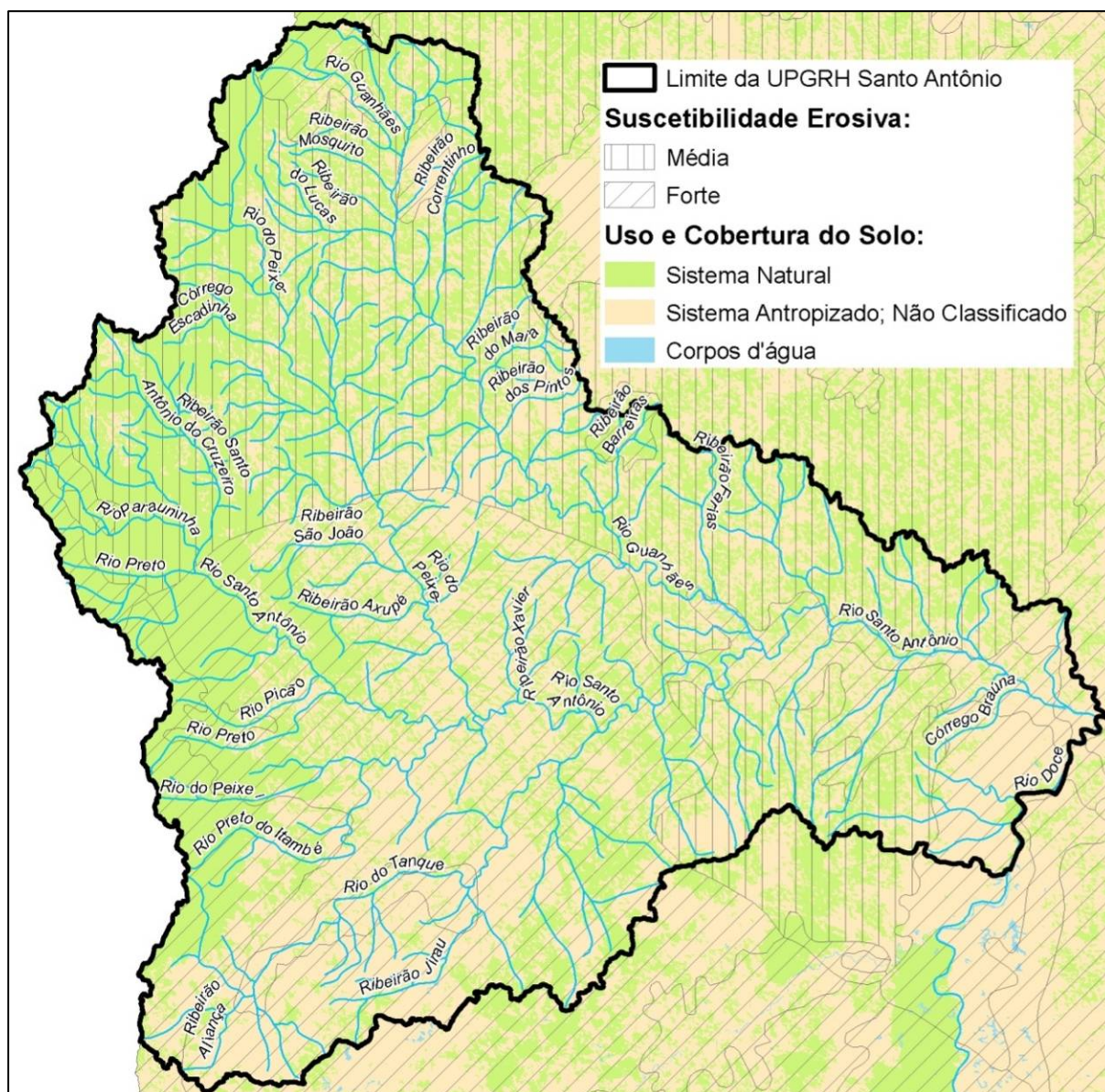
Figura 13 – Cruzamento das informações de suscetibilidade à erosão em relação aos usos dos solos na UPGRH DO3
